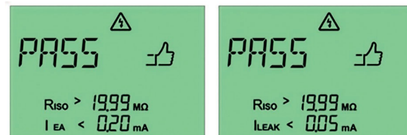
36. ábra: Megfelelt mérés az alternatív szivárgási áram módszerrel (balra) és a differenciális áram módszerrel (jobbra) egy II. védelmi osztályú eszköz esetében
