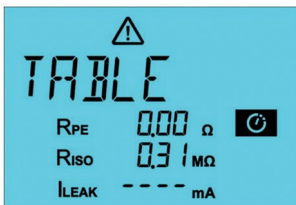
21. ábra: Mérési folyamat megszakítva; ellenőrizze a mérési értéket, és folytassa a mérést, ha szükséges vagy megszakítani
