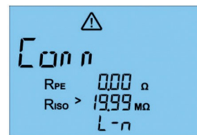
45. ábra: Az áramvezető vezeték csatlakozásának ellenőrzése
