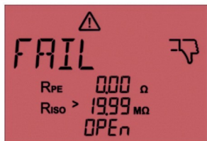
47. ábra: Sikertelen mérés. A kijelzőn az „OPEN” felirat jelenik meg. Vezetéksatlakozás megszakadt/kapcsoló nyitva
