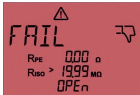
47. ábra: Nem megfelelő mérés. A kijelzőn „OPEN” jelenik meg. Vezetéksatlakozás megszakadt/kapcsoló nyitva
