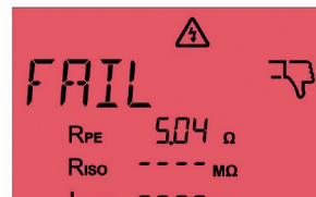
16. ábra: Mérési folyamat megszakítva; ellenőrizze a mért értéket, és folytassa vagy szakítsa meg, ha szükséges
