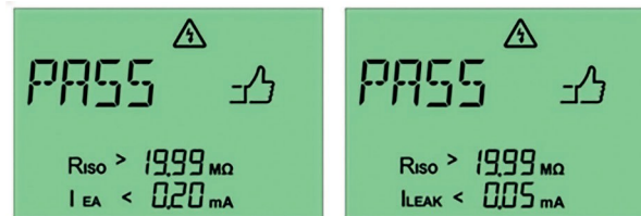
36. ábra: Sikeres mérés a helyettesítő szivárgási áram módszerrel (balra) és a különbségáram módszerrel (jobbra) egy II. érintésvédelmi osztályú készüléknél
