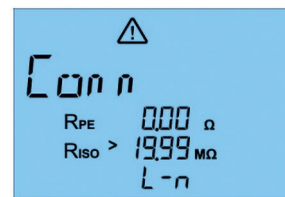
45. ábra: Az áramvezető vezeték csatlakozásának ellenőrzése
